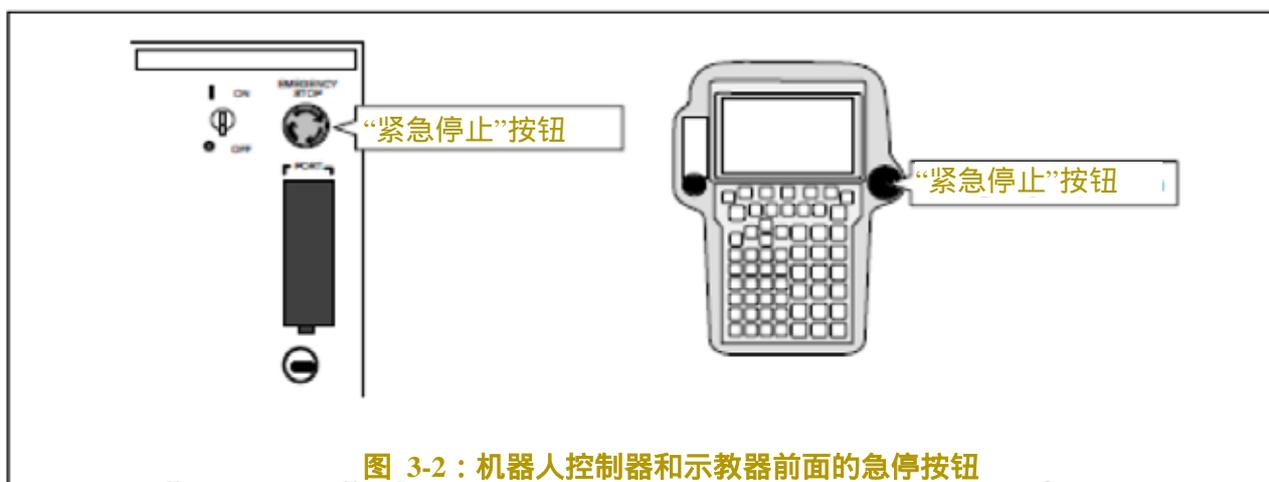
图 3-2：机器人控制器和示教器前面的急停按钮
